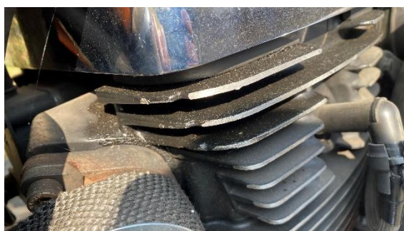
Patrné drobné úniky prov. kapalin
